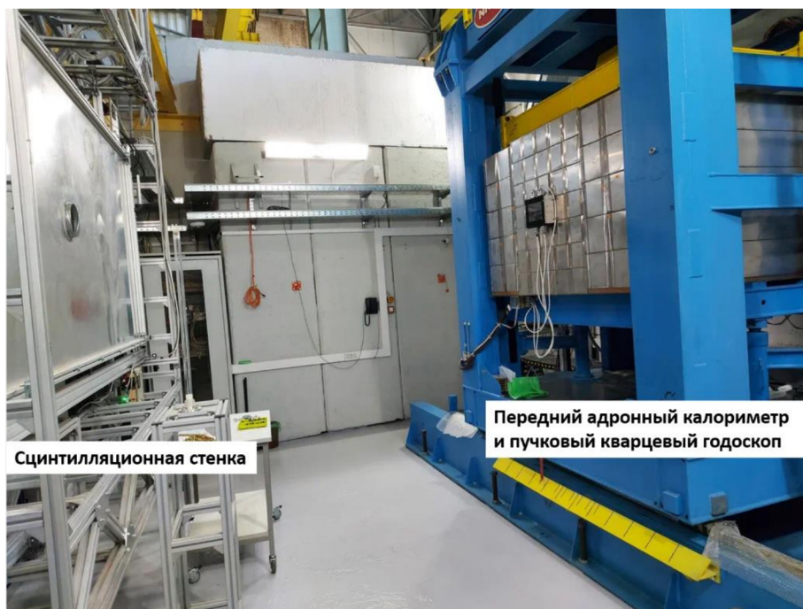
Рисунок 1. Расположение передних детекторов, разработанных и изготовленных в ИЯИ РАН, на установке BM@N в ОИЯИ.
