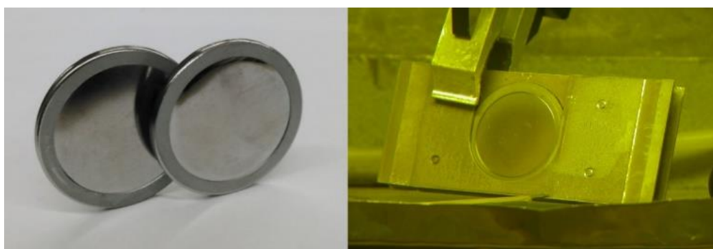
Рисунок. Мишени из металлического тория в ниобиевой оболочке для получения актиния-225 (слева – до, справа – после облучения на линейном ускорителе ИЯИ РАН)
