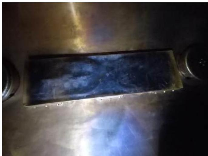
Рисунок 7 – Следы перегрева стационарного элемента настройки
