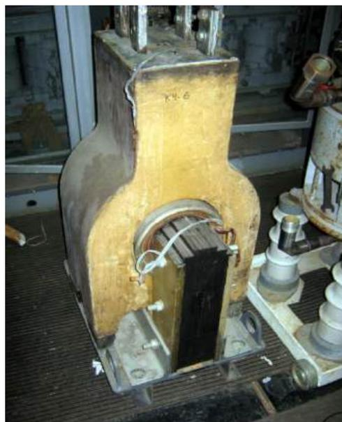
Рисунок 17- Накальные трансформаторы для модуляторных ламп ГИ-71А (слева) и ГМИ-44А (справа)
