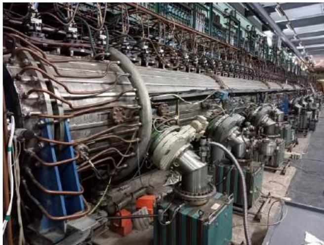
Рисунок 3 – Внешний вид второго ускоряющего резонатора с трубками дрейфа в тоннеле ускорителя
