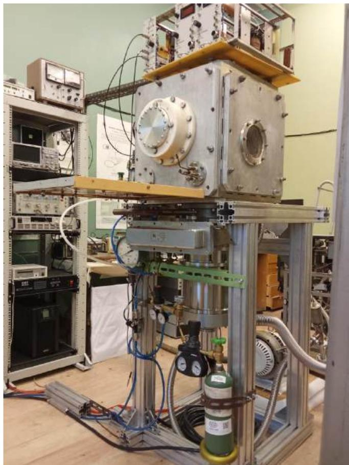
Рисунок 14 - Общий вид стенда для испытаний источника отрицательных ионов
