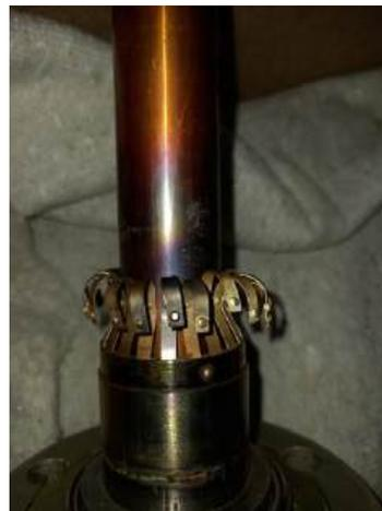
Рисунок 8 – Пример последствий нарушения контактов стабилизирующего стержня
