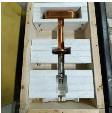
Рисунок 4 – Изготовленная трубка дрейфа №318 в упаковочной таре
