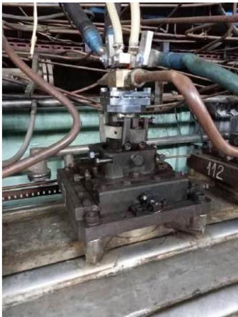
Рисунок 6 – Внешний вид механизма юстировки трубки дрейфа №218
