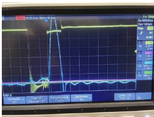
Рисунок 17 – Осциллограммы напряжения на разряде (верхний луч) и тока разряда (нижний луч)
