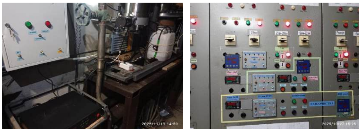
Рисунок 19 – Пост предварительной откачки на канале нейтронного источника «РАДЭКС» и пульт дистанционного управления постами
