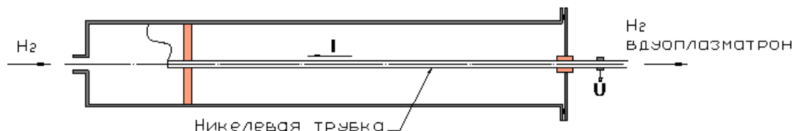
Рисунок 2 – Схема фильтра-накателя водорода в дуоплазматрон
