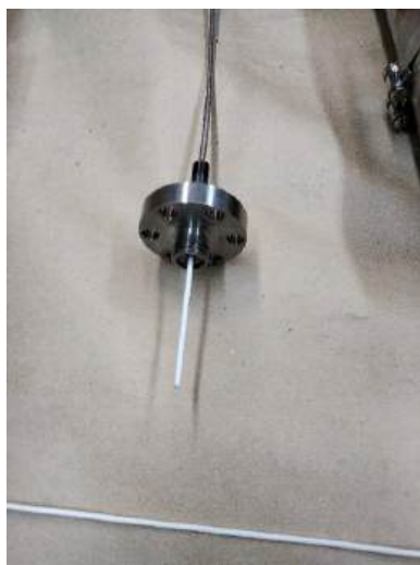
Рисунок 4 – установка корундовой трубки в никелевый фильтр-натекатель
