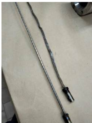
Рисунок 3 – Никелевые трубки фильтра водорода до (слева) и после (справа) работы в натекателе водорода
