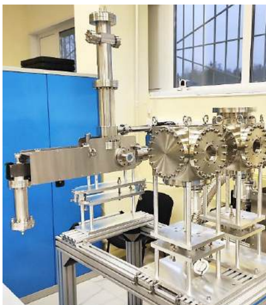
Рисунок 26 – Фазовый анализатор сгустков (слева) и два ионизационных монитора (справа) на испытательном лабораторном стенде
