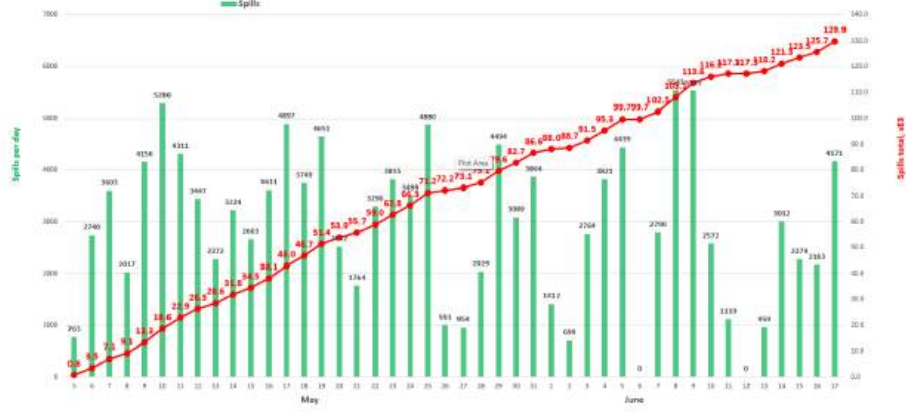
Рисунок 12.6 — Количество сбросов пучка по дням в сеансе 2025 года на электронном пучке канала Н4
