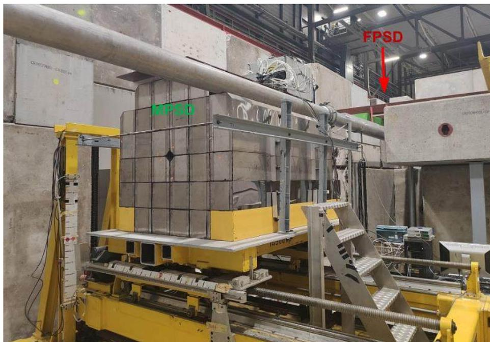
Рисунок 7.3 – Система калориметров MPSD и FPSD на установке NA61/SHINE
