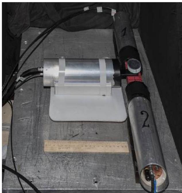
Рисунок 9.5 – Фотография сцинтилляционных детекторов и  $\beta^-$ -источника, собранных для проведения описываемых в настоящем отчёте исследований
