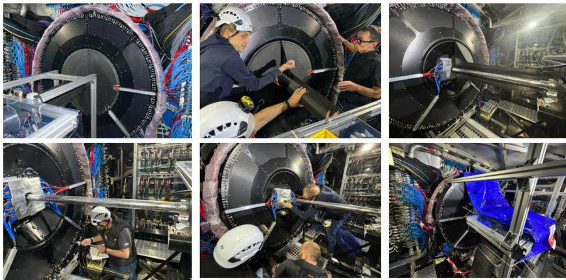
Рисунок 1.3 – Разборка детектора FIT-A
