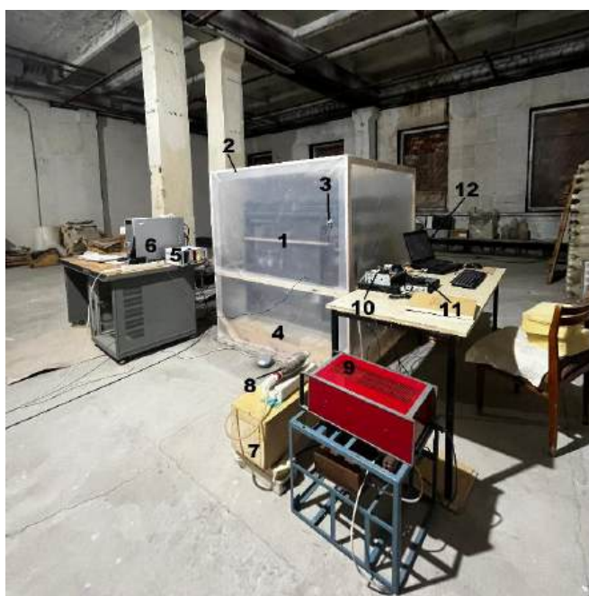
Рисунок 33 – Фото наземной низкофоновой установки со сцинтилляционным детектором для контроля скорости выхода ^{222}\text{Rn} из грунта: 1) свинцовая защита с внутренним стальным каркасом; 2) воздухонепроницаемый полиэтиленовый шатёр; 3) трубка с нагревательным элементом внутри; 4) деревянный помост; 5) высоковольтный источник; 6) компьютер со встроенным анализатором; 7) ящик с цилиндрической воздушной ионизационной камерой (ЦВИК) внутри; 8) емкость с силикагелем; 9) высоковольтный источник ЦВИК; 10) продувочный компрессор с платой ARDUINO; 11) анализатор ЛА-н10-12РСІ; 12) ноутбук для мониторинга сигналов с ЦВИК
