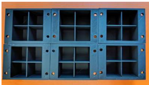
Рисунок 6.11 – Слева – светоизолирующие корпуса для CsI(Tl) кристаллов. Справа – процедура сборки CsI(Tl) детектора
