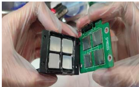
Рисунок 6.11 – Слева – светоизолирующие корпуса для CsI(Tl) кристаллов. Справа – процедура сборки CsI(Tl) детектора
