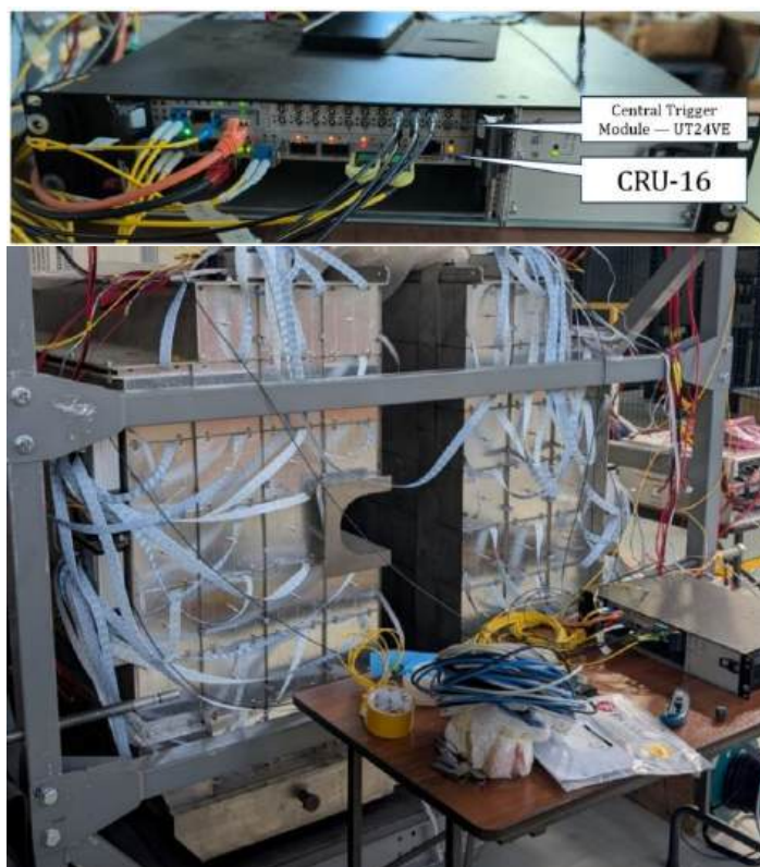
Рисунок 6.6 – Система считывания сигналов с FHCAL. Вверху – фотография крейта, в котором установлены ключевые модули системы: центральный триггерный модуль и модуль общего считывания. Внизу – собранное плечо FHCAL калориметра с системами считывания и питания АЦП
