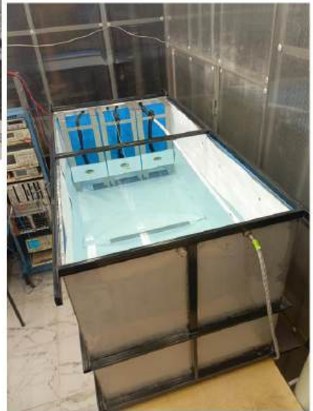
Рисунок 4 – Тестовый водный черенковский детектор Toddler-K в ИЯИ РАН. Таблицы: световой сигнал ФЭУ+пластина для различных конфигураций и двух разных ФЭУ NNVT N2031 (Китай) и R14374 Hamamatsu (Япония). Bare PMT – один «голый» ФЭУ без пластины; PMT-cap – ФЭУ+СПП: ФЭУ закрыт, сбор света только пластиной; PMT+WLS – полный модуль OD, ФЭУ+СПП: ФЭУ открыт: свет с пластины + прямой
