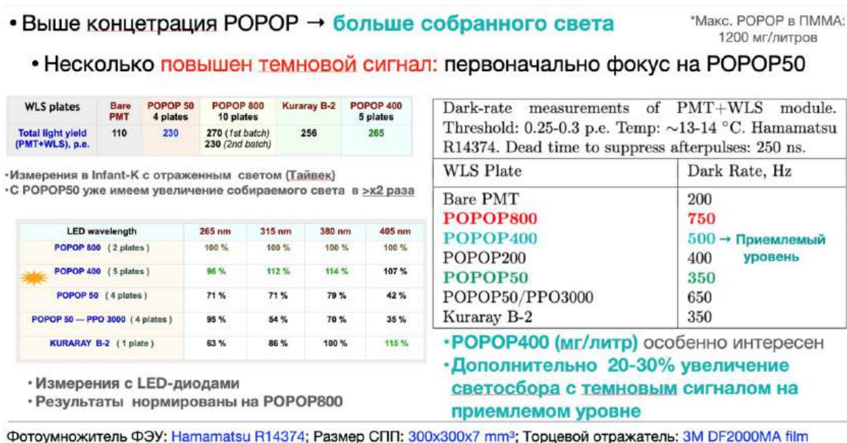
Рисунок 2 – Обобщение различных результатов ИЯИ РАН по измерению параметров пластин (слева: световой сигнал, справа: темновой сигнал)
