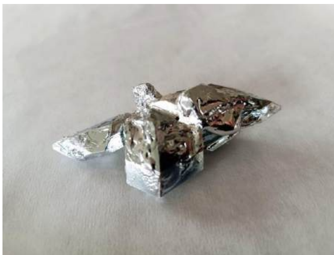
Рисунок 16 – Кристаллы Ga, сформировавшиеся на монокристаллической заправке
