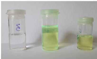
Рисунок 5. Фотография двух образцов жидких сцинтилляторов с кремнийорганическими добавками Skm219 (справа и в центре) и стандартный сцинтиллятор с LAB+PPO (слева)
