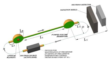
Рис.5. Принцип работы литиевого источника с управляемым  $\tilde{\mathbf{v}}_e$ -спектром (управляемый режим) на базе ядерного реактора. Указанные параметры использованы в расчетах  $\tilde{\mathbf{v}}_e$ -потоков. Активная зона (AZ), соответствующая объему AZ реактора ПИК окружена слоем литиевого бланкета с толщиной слоя  $L_B$
