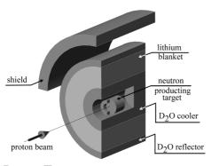
Рис.11. Принципиальная схема литиевого  $\tilde{\mathbf{v}}_e$ -источника в тандеме ускорителя с нейтронно-генерирующей мишенью плюс литиевый бланкет
